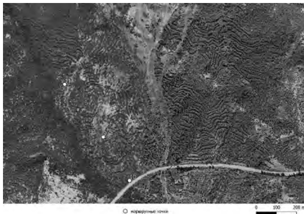
Рисунок 6 – Активный оползень «Сарыч», подрезаемый автодорогой «Ялта-Севастополь». Внемасштабными знаками показаны точки наблюдения. На снимке отчетливо видны следы террасирования
