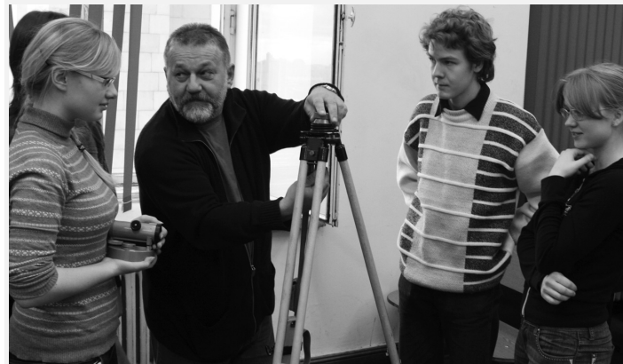
«Ось цилиндрического уровня должна быть параллельна оси визирования!»
