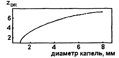
Рис. 20. Зависимость дифференциальной отражаемости от диаметра каплей
