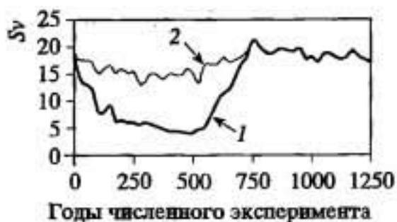
Рис. 6.11. Сглаженные высокочастотным фильтром изменения интенсивности термохалинной циркуляции Северной Атлантики (определяемые по максимальному значению ее функции тока), воспроизведенные в численных экспериментах при распреснении Северной Атлантики (50–70° с.ш.) (1) и субтропической части Западной Атлантики (20,25–29,25° с.ш., 52,5–90° з.д.) (2)
