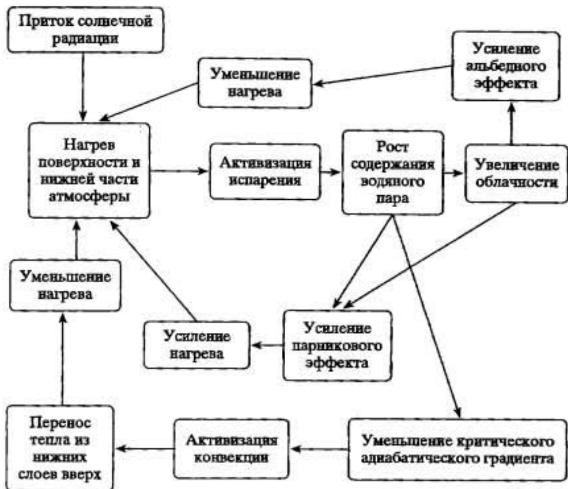
Рис. 2.8. Принципиальная схема радиационно-конвективного теплообмена
