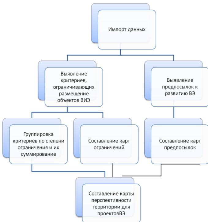
Рис. 2.8. Структурированный подход к решению задачи поиска оптимальных территорий для размещения объектов на ВИЭ
