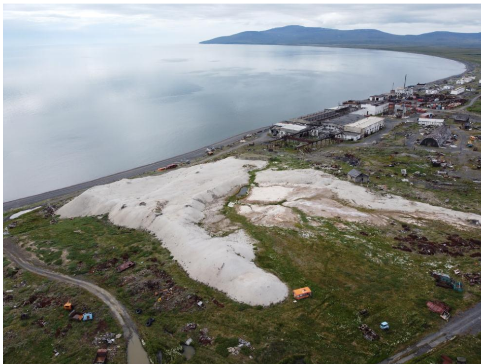
Рис.5. Гравийно-дресвяные отвалы обогатительной фабрики в пос. Западном (Первом). Правее отвалов — здание фабрики, на заднем плане — массив горы Певек (616 м)
