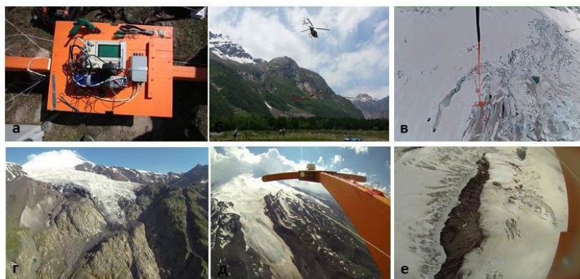
Рис. 2.1.2. Аэрорадиозондирование ледников Эльбруса: а) установка радиолокационного оборудования на ферму; б) оборудование во время взлета вертолета; в) ферма, подвешенная к вертолету во время измерений толщины льда, вид с камеры под вертолетом; г) вид с камеры на носу фермы; д) ферма во время измерений, вид с камеры на хвостовом стабилизаторе; е) вид с камеры вертикально вниз с поперечной балки фермы
