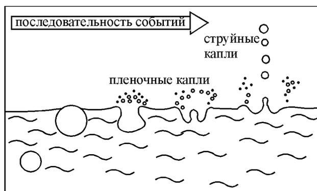
Рис. 4.1. Формирование капель при разрыве пузырька воздуха
