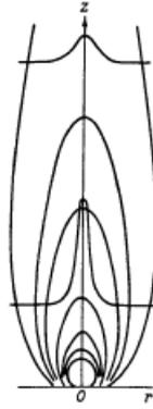
Рис. 9.1. Изолинии и профили  $\mathcal{G}$  в осевом сечении термика (схематический чертеж).
