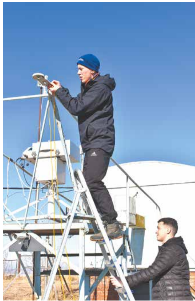
Установка балансомера Kipp & Zonnep на плато Шаджатмаз
